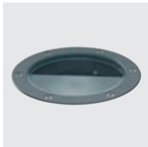
Verre partiellement dépoli à l'intérieur pour adoucir les côtés du faisceau contre le mur et donner une ligne nette horizontale en bas.
